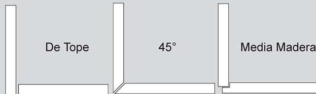
Sistema de Revestimientos de Muro de MDF 12 mm enchapado en madera natural, barnizado UV. Además hay alternativas de terminación como láminas de PVC o laminado de alta presión ("formalita").
